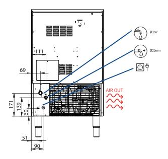
\* All measurements in mm. \* Todas las cotas en mm.
